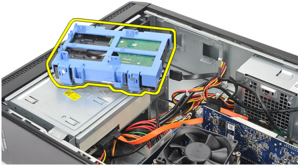
6. ดึงสายรัดสองเส้นออกจากฮาร์ดไดรฟ์ และขยฮาร์ดไดรฟ์ออกจากหุ้ฮาร์ดไดรฟ์
